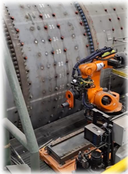
Figura 4. Brazo Robótico para cambio de pernos de sujeción de liners de molino de bolas.
